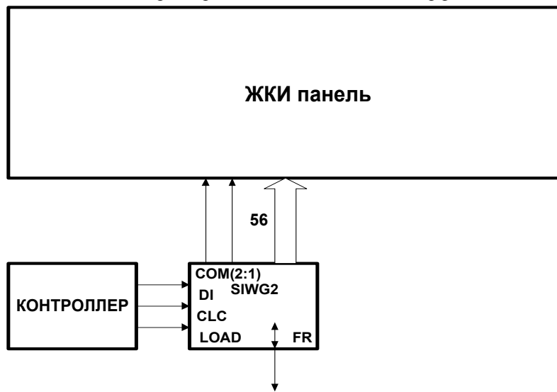
Рис. 14 Схема включения мс SIWG2 в одиночном режиме для управления ЖКИ с мультиплексом 1/2
